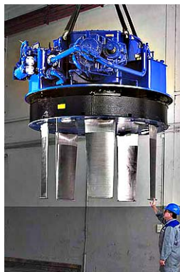
Picture 2 Voith Schneider propeller
